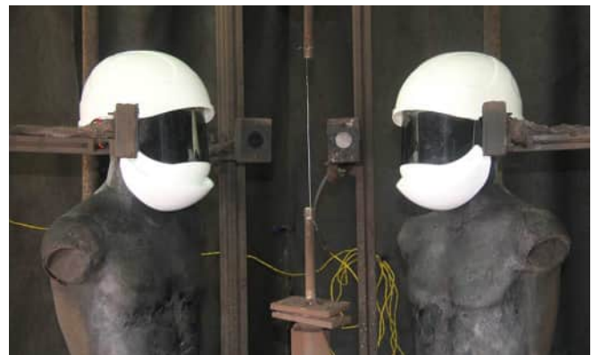
Abb. A 2-2 ATPV-Testaufbau
