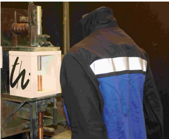
Abb. A 2-1 Prüfaufbau Box-Test Verfahren
